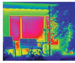
Infrarotaufnahmen – Thermografien – zeigen deutlich, wo ein Haus unkontrolliert Energie verliert. Rot bedeutet Wärme- und damit Energieverlust.
