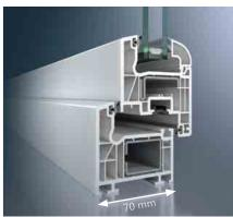
Hohe Basissicherheit: Die Bautiefe von 70 mm und weit innen liegende Beschläge entziehen die Verschlusselemente dem Angriff der Einbrecher.
