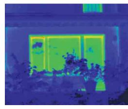
Nach dem sorgfältigen Einbau neuer Schüco Corona CT 70 Classic Fenster beweist die Thermografie den hohen energetischen Nutzen der Investition. Der ursprüngliche Energieverlust wird nahezu vollständig vermieden.
